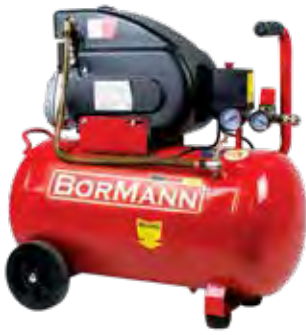
ΑΕΡΟΣΥΜΠΙΕΣΤΗΣ ΛΑΔΙΟΥ 230V/ 50HZ 2.0HP 8 BAR/ 116PSI
