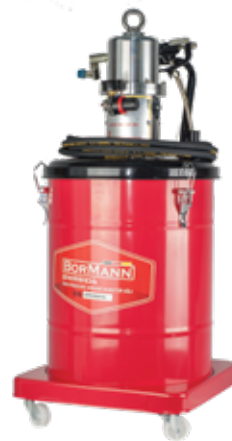
BWR5104 016823 Γρασσαδόρος αέρος τροχήλατος • Πίεση αέρα 6-8bar • Ικανότητα αντλίας 0.85L/min • Πίεση εξόδου 300-400bar • Χωρητικότητα 45Lt • Περιλαμβάνει: Πιστόλι γράσου, ελαστικό σωλήνα 4m, 6mmx16mm
