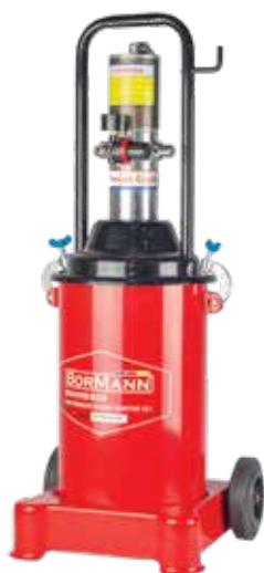
BWR5103 016816 Γρασσαδόρος αέρος τροχήλατος • Πίεση αέρα 6-8bar • Ικανότητα αντλίας 0.85L/min • Πίεση εξόδου 300-400bar • Χωρητικότητα 12Lt • Περιλαμβάνει: Πιστόλι γράσου, ελαστικό σωλήνα 4m, 6mmx16mm
